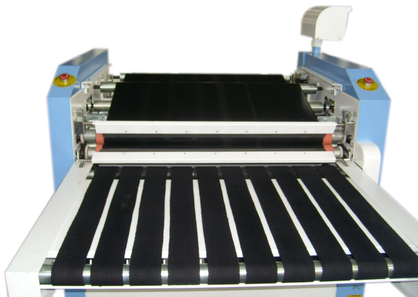
图 3A、更换输送带步骤之 1、2、3 之后 即已取去整个上护罩及隔热板
